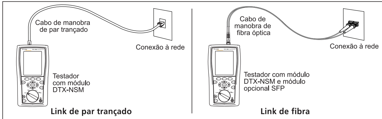
Figura 23. Conexão para testes de rede
